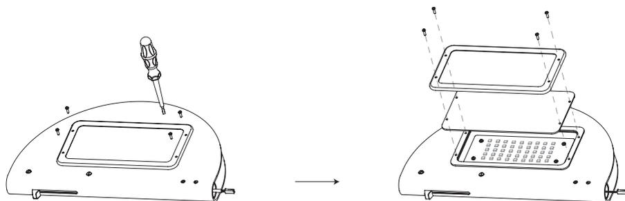
**Retirer les 4 vis pour libérer la source LED à remplacer.
