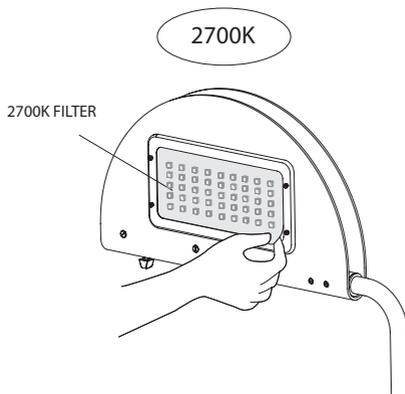
**3. Pour une lumière très chaude: le remplacer par le filtre à 2400 Kelvins. Simplement glisser les encoches du filtre entre la plaque acrylique et le porte-filtre métallique. Pour une lumière blanc neutre: ne rien ajouter.**
