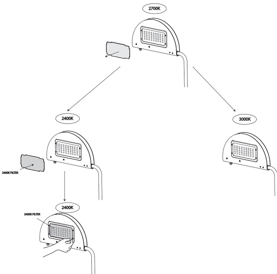
**4. Pour les deux cas de figures: remplacez le film diffusant, afin de réduire les points LED.**
