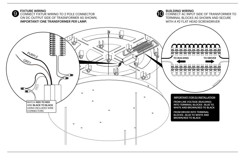
NOTE: PURPLE AND GREY CORDS ARE USED ONLY WITH 0-10 V DIMMER SWITCH AND SHOULD NEVER BE ATTACHED TO THE TERMINAL BLOCK. CONTACT PABLO IF FURTHER INSTRUCTION IS REQUIRED.
