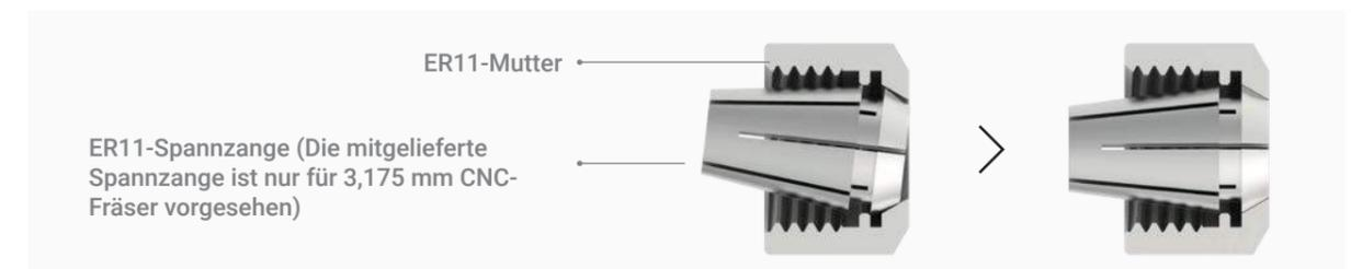
2. Setzen Sie die CNC-Schutzbrille auf. Setzen Sie den CNC-Fräser in die ER11-Spannzange ein (für unser bereitgestelltes Modell ist ein Flachfräser erforderlich). Drücken Sie den CNC-Fräser weiter, bis sein Anschlag die Hülse der ER11-Spannzange berührt.
