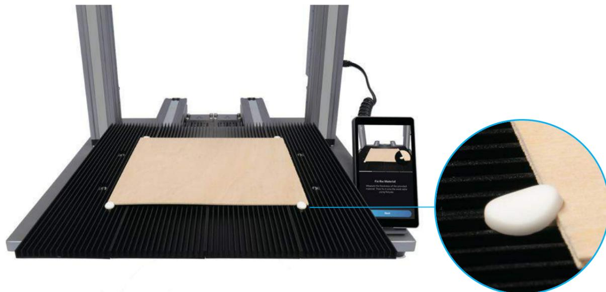
3. Tippen Sie auf **X-, X+, Y-, Y+, Z-,** oder **Z+** um das Lasermodul zu bewegen. Nachdem die Objektivhülse der Laserkamera die Oberfläche des Materials leicht berührt hat, tippen Sie auf **Weiter**. Setzen Sie die Laserschutzbrille auf, bevor Sie den Arbeitsursprung einstellen.
