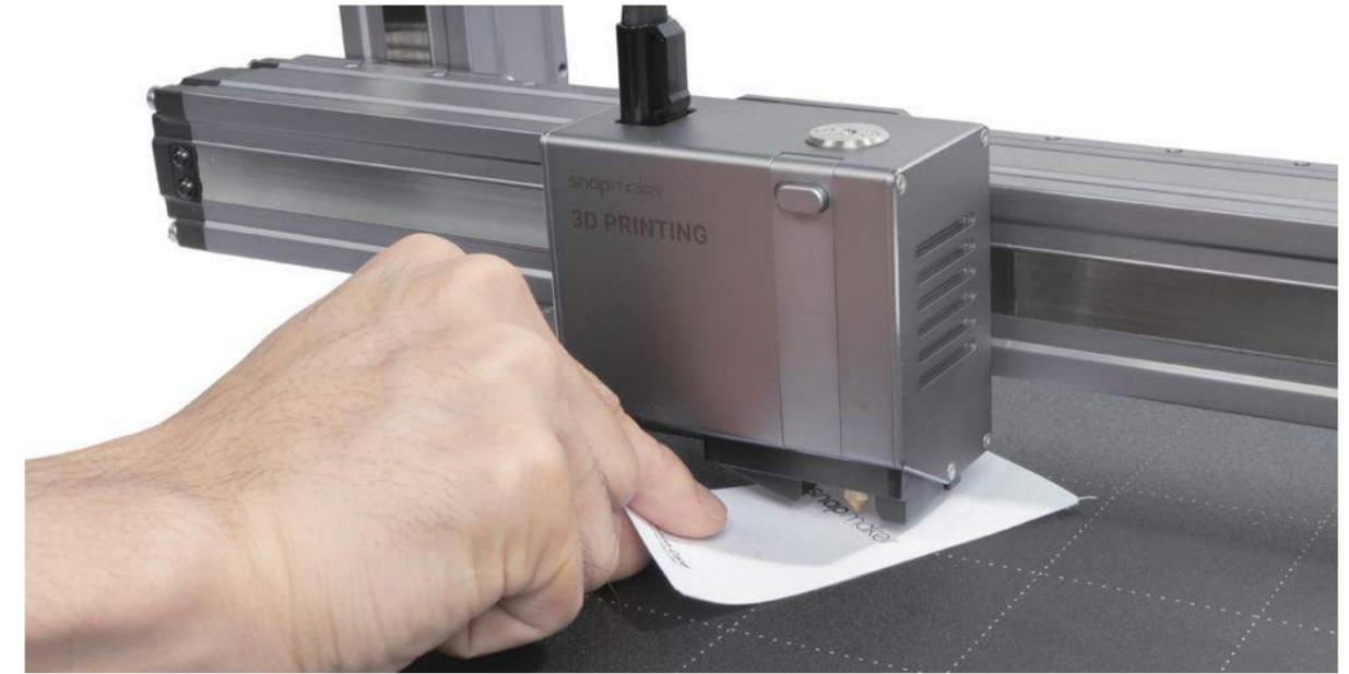
3. Stellen Sie die Höhe der Düse weiterhin anhand der **Auf** und **Nach unten** Tasten, bis Sie einen leichten Widerstand beim Herausziehen der Kalibrierkarte spüren. Die Kalibrierkarte sollte sich zerknittern, wenn Sie sie nach vorne schieben. Tippen Sie auf **Speichern** um die Kalibrierungseinstellungen zu speichern.
