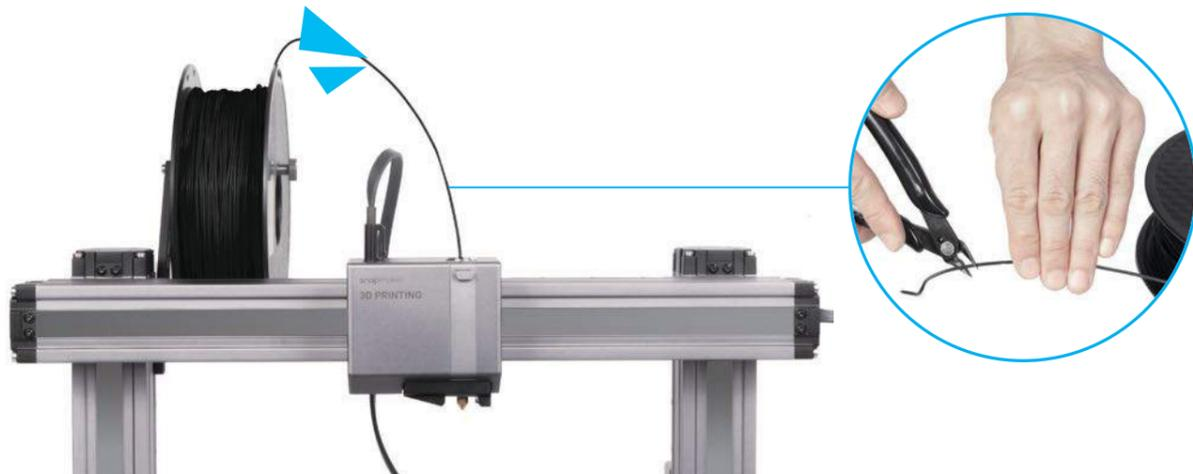
2. Tippen Sie auf **Start** auf der **Filament Laden** Anzeige. Nachdem die Temperatur die Zieltemperatur erreicht hat, tippen Sie auf **Laden** und drücken Sie dann das Filament vorsichtig in das 3D-Druckmodul, bis Sie spüren, wie der Motor das Filament einzieht.
