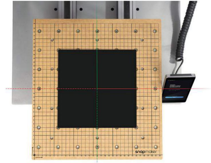
2. Bringen Sie das Klemmsset an der CNC-Fräsplattform an, und befestigen Sie dann das Material durch Verschrauben der Flügelmutter.
