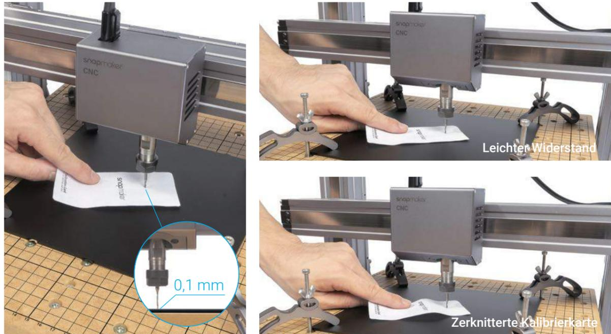
4. Tippen Sie auf **Z+**, um den CNC-Fräser anzuheben, bis er sich über dem Klemmsatz befindet, und tippen Sie dann auf **Ausführungsgrenze**, um zu prüfen, ob der Arbeitsursprung korrekt ist. Wenn ein Teil der vom CNC-Fräser gezogenen Begrenzung außerhalb des Materials liegt oder wenn der CNC-Fräser auf Teile des Gerätes stößt, setzen Sie den Arbeitsursprung zurück und führen Sie die Begrenzung erneut aus.
