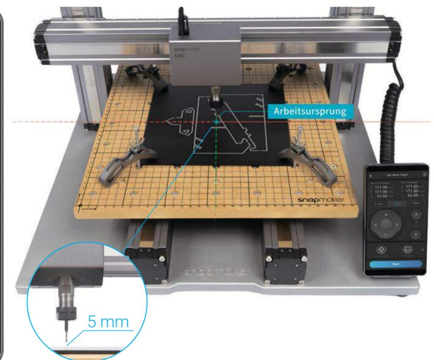
3. Legen Sie die Kalibrierkarte oder ein Stück A4-Papier zwischen den CNC-Fräser und das Material. Stellen Sie die Höhe des CNC-Fräasers mit Hilfe der Tasten **Z-** oder **Z+** so lange ein, bis Sie beim Herausziehen der Kalibrierkarte einen leichten Widerstand spüren und sie beim Vorwärtsschieben zerknittern sollte. Tippen Sie auf **Arbeitsursprung einstellen**.
