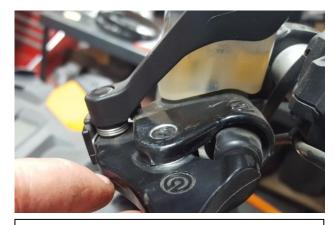
1. Remove brake lever bolt.
