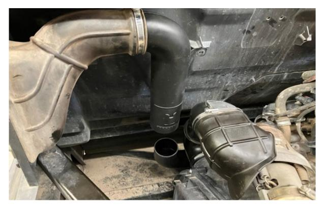
INSTALL THE BOTTOM HALF OF THE INTAKE TUBE ONTO THE CLUTCH HOUSING FIRST. NEXT INSTALL THE EXHAUST TUBE ONTO THE CLUTCH HOUSING. THEN INSTALL THE TOP HALF OF THE INTAKE TUBE INTO THE INTAKE SCREEN BOOT THAT IS ATTACHED TO THE SIDE OF THE MACHINE.
