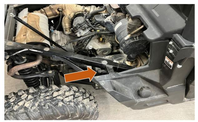
YOU WILL RUN THE BLOWHOLE POWER WIRE ALONG THE CAB BACK WALL, BEHIND THE COOLANT OVERFLOW RESERVOIR, UNDER THE AIR FILTER HOUSING TO GET TO THE RIGHT SIDE OF THE MACHINE. THE POWER WIRE WILL BE CONNECTED TO THE TAILLIGHT HARNESS CONNECTOR THAT IS LOCATED RIGHT BY THE VOLTAGE REGULATOR. UNPLUG THE FACTORY TAILLIGHT CONNECTOR AND PLUG THE BLOWHOLE CONNECTOR INLINE WITH THE FACTORY CONNECTOR. THIS WILL NOW POWER THE BLOWHOLE AND TAILLIGHTS.
