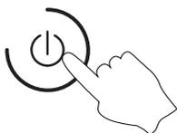
按下电源键，外圈圆环透出红色灯光，产品处于开机状态，已做好准备，等待工作指令。“电源”键图标亮时，如果只有照明灯亮，轻触“电源”键将直接关闭照明灯；如果“电源”开启时风机正在工作，轻触“电源”键，电源键图标将闪烁，烟机进入延时工作状态，一分钟后关闭风机；如果电源键图标闪烁时，再轻触“电源”键，则关闭所有功能。
