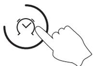
按一次定时提醒键，定时显示区显示“1”，表示定时提醒时间为10分钟，10分钟后油烟机将会发出“叮……”声来提醒定时已到。若按2次，则定时显示区显示“2”，表示提醒时间为20分钟，依次循环，最长为60分钟。提醒时间到后，按下任意键，取消定时器提示音。
