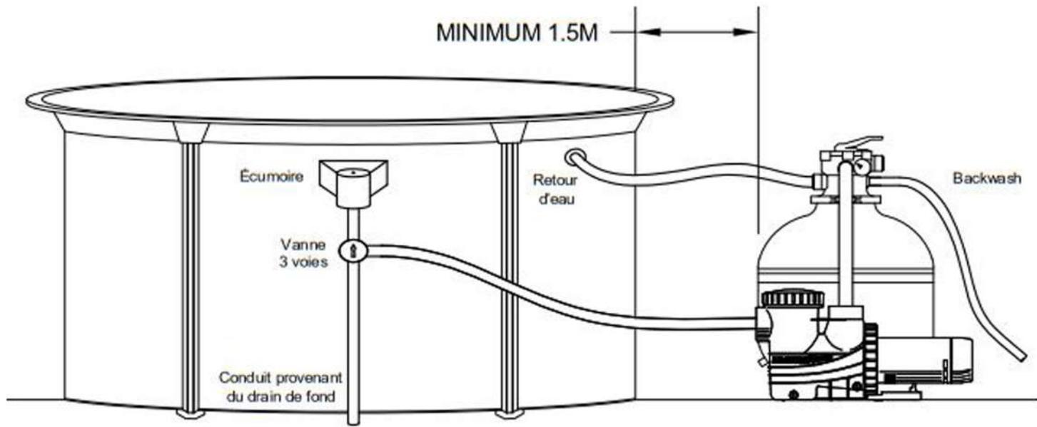
Schéma des raccordements
