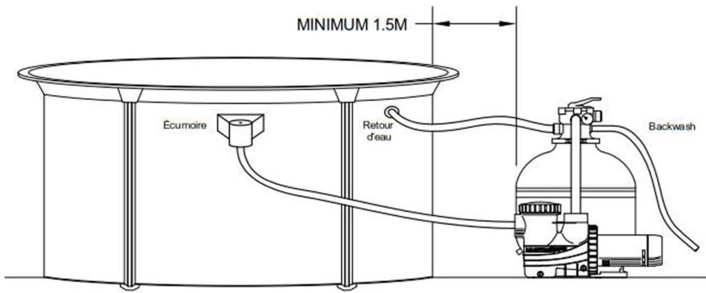
Schéma des raccordements
