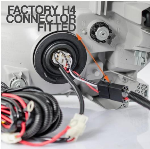
Entfernen Sie Ihren werkseitigen H4/HB3-Stecker von der Rückseite der Fernlichtlampe Ihres Autos und schließen Sie ihn an die Buchse des mitgelieferten Kabelbaums an. Schließen Sie dann die andere H4/HB3-Buchse an die Rückseite Ihrer Fernlichtlampe an.
