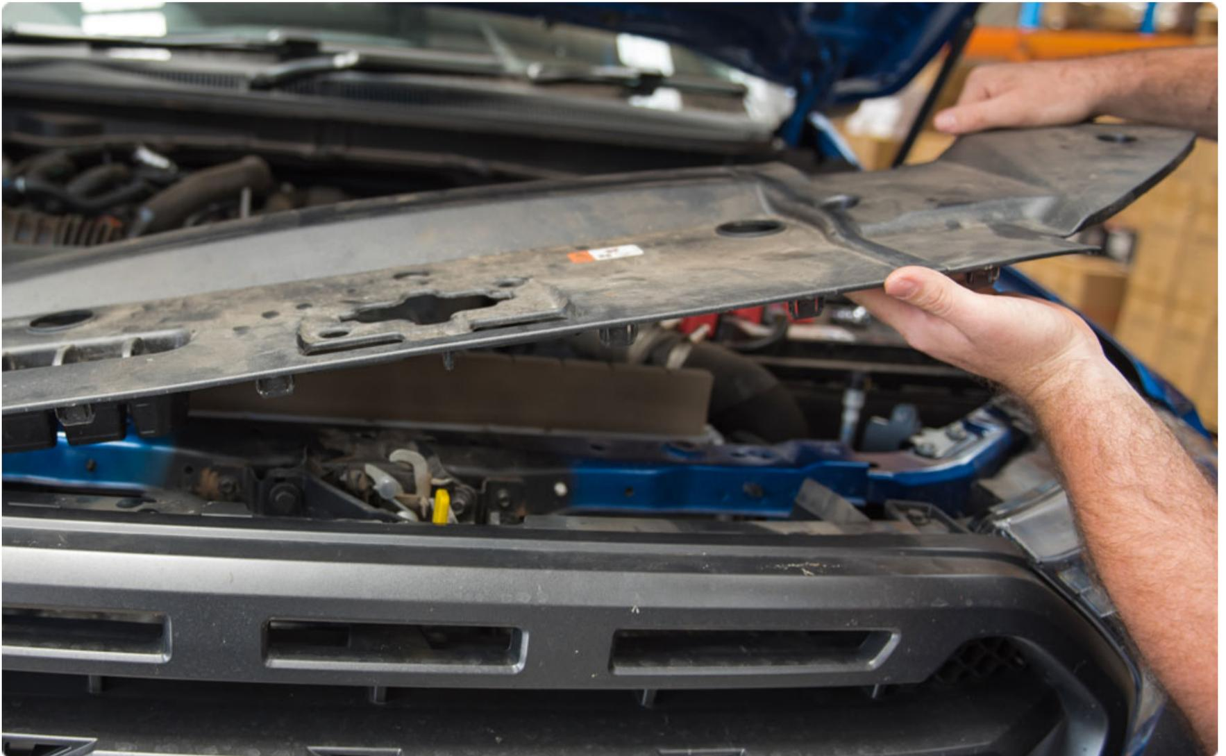
1. Entfernen Sie die Kühlerabdeckung, um Zugang zu den Schrauben des oberen Grills zu erhalten.
