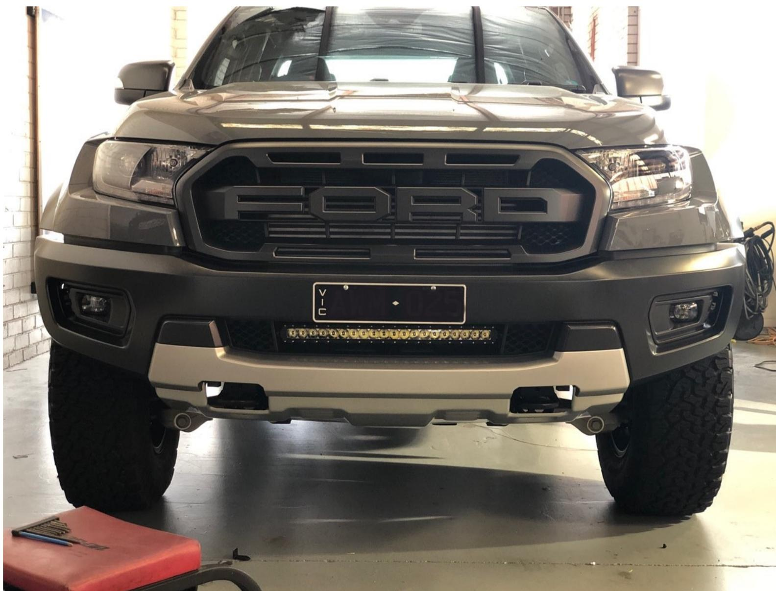
7. Befolgen Sie die notwendigen Schritte, um den Kabelbaum zu installieren und gehen Sie nachts mit einem Inbusschlüssel hinaus und stellen Sie die Ausrichtung des Lichtbalkens ein.
