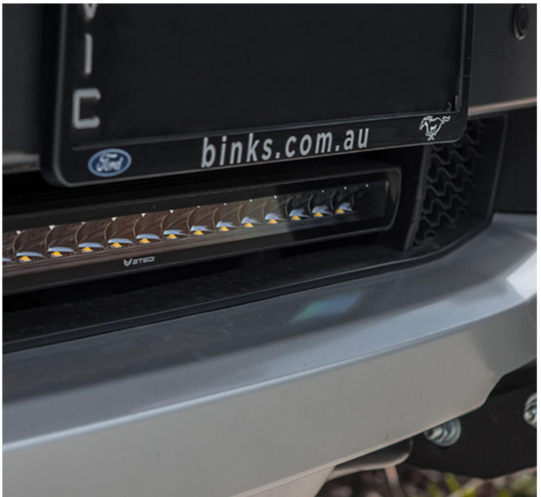
Die Halterungen für den unteren Kühlergrill wurden ursprünglich für den PX2 Ranger entwickelt; mit minimalen Änderungen bei der Installation passen sie jedoch problemlos auf den Ranger Raptor. Einige Ranger Modelle haben bereits vorgebohrte Löcher für die problemlose Montage am Fahrzeug. Bitte prüfen Sie das vorher.
