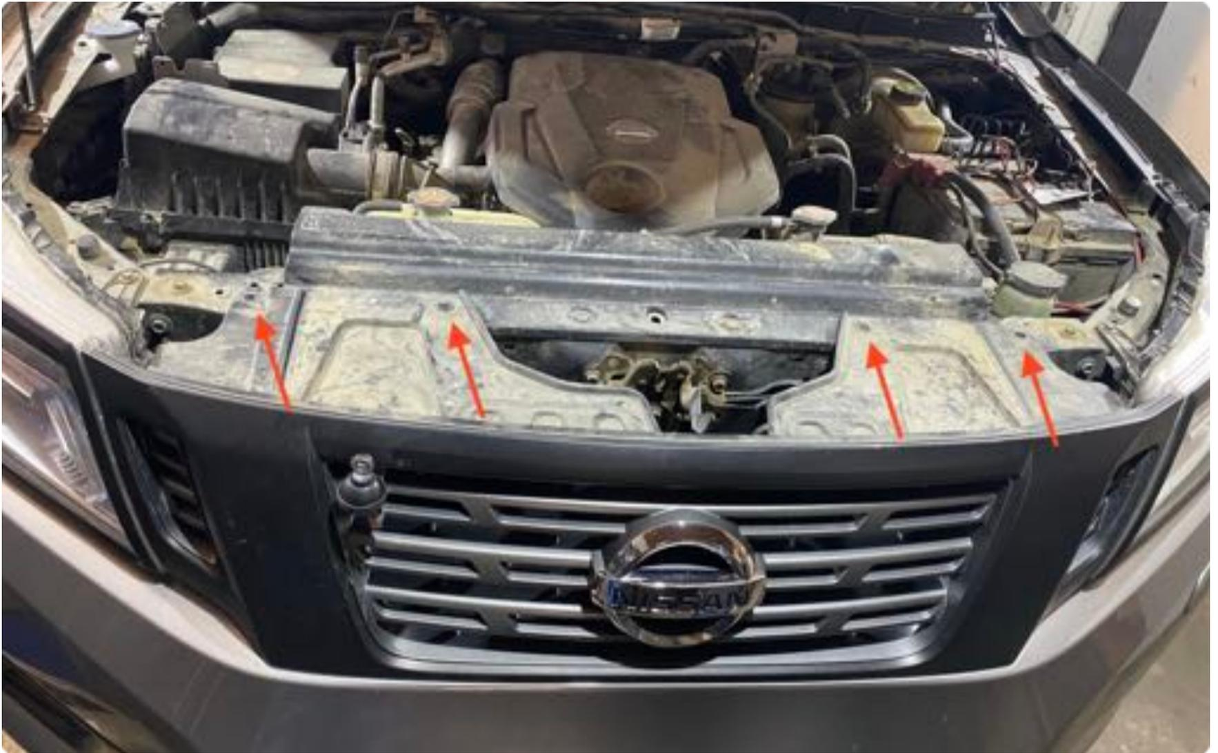
Öffne die Motorhaube und entferne zunächst alle Clips von dem Kühlergrill.
