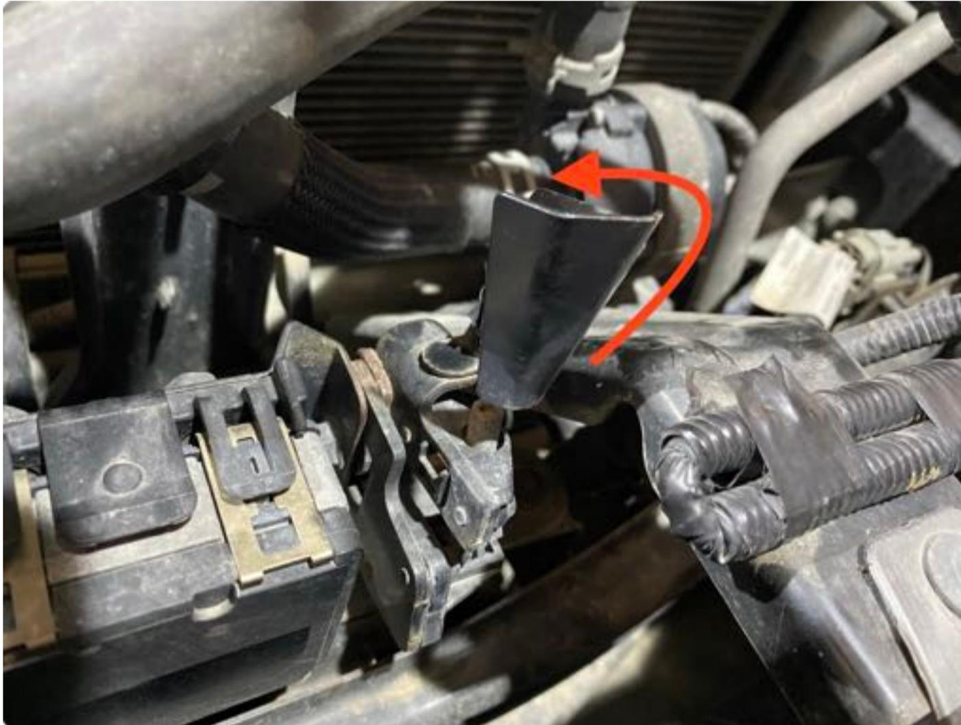
Danach muss das Kabel der Kamera auf dem Träger entfernt und nach unten versetzt werden.
