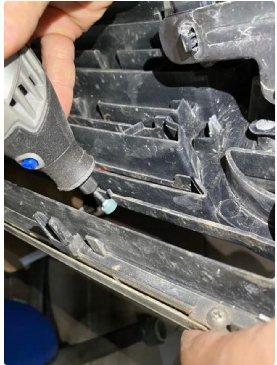
Bei Bedarf kannst du die Kanten mit einer Fräse bearbeiten.
