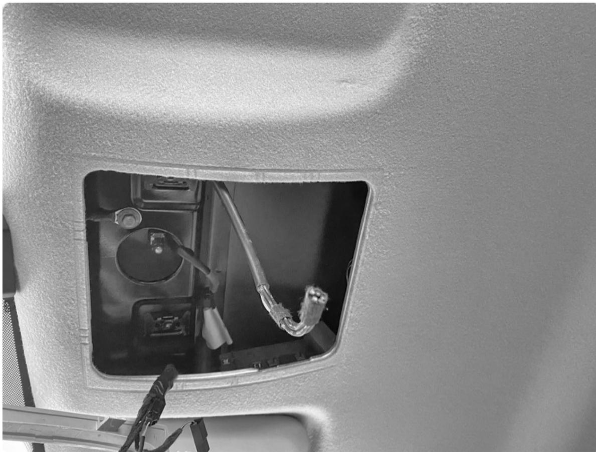
Nun können Sie den Außenkabelbaum von innen nach Außen durch die Gummidurchführung im Fußraum ziehen. **Wichtig: Das Ende mit dem Stecker muss im Innenraum bleiben.**
