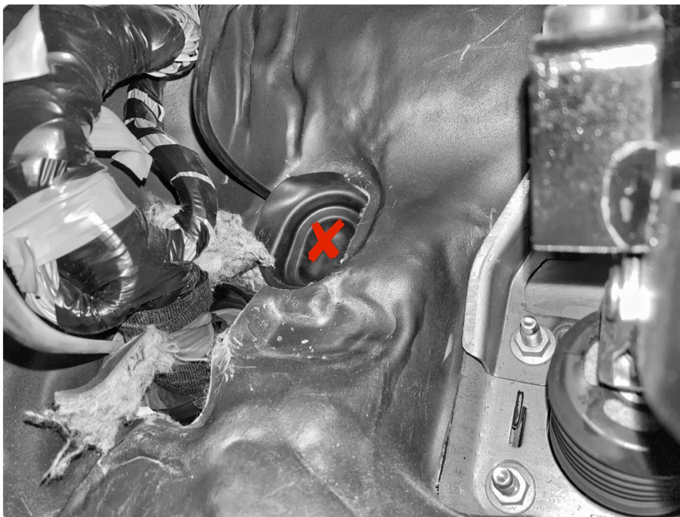
Nehmen Sie eine zweite Person zur Hilfe die von außen das Kabel entgegen nimmt und mit nach außen zieht.
