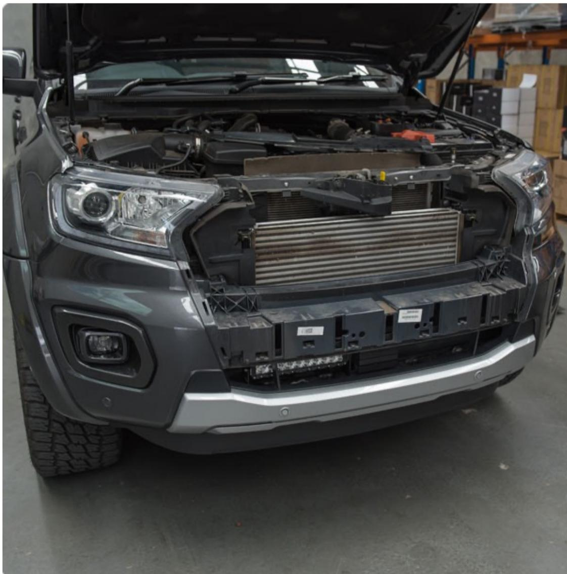
**Der Kühlergrill muss entfernt werden, ebenso die Kühlerabdeckung, um den besten Zugang zum Aufprallträger zu erhalten. Auf dem unteren Foto sind 2 Clips zu sehen.**
