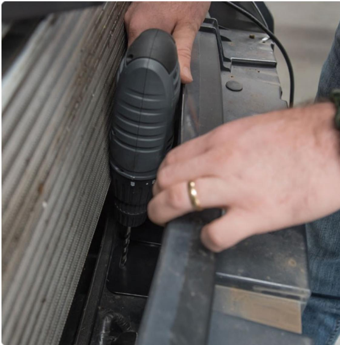
Nachdem Sie das Gitter entfernt haben, bringen Sie die Halterungen in die richtige Position und setzen Sie die Leuchte auf, damit Sie beim Bohren die richtigen Abstände haben. Sobald beide Halterungen in Position sind, bohren Sie die Löcher für die beiden kleineren Halterungen, am besten mit einer kabelgebundenen Bohrmaschine, die nicht die zusätzliche Dicke des Akkupacks hat.
