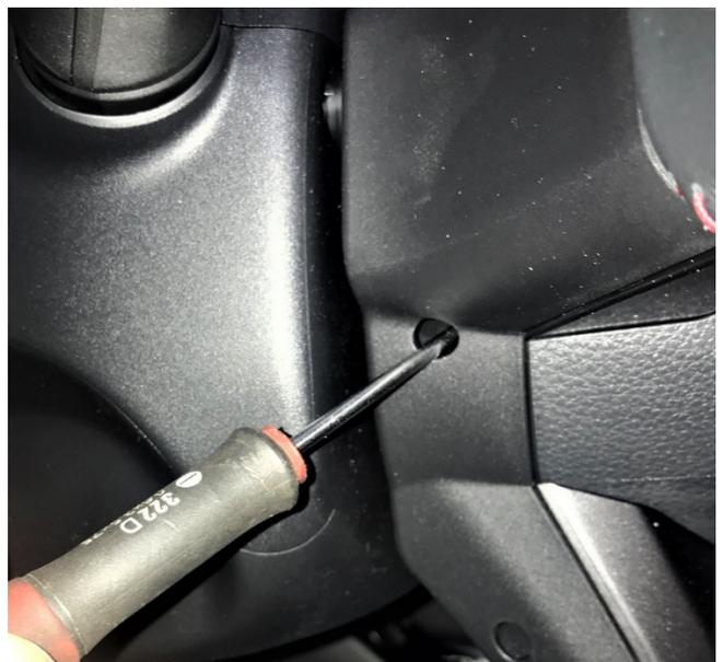
Guardare bene dove si trovano le molle di rilascio dell'airbag, anche spendendosi in scomodi contorsionismi intorno al volante, prima di intraprendere l'opera di sgancio.
