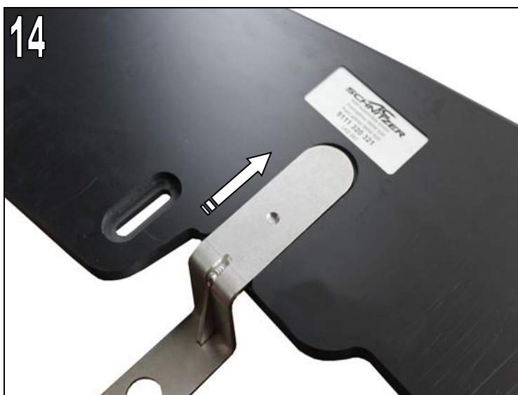
Abb. 14 AC Schnitzer Befestigungshalter in AC Schnitzer Frontsplitter, wie abgebildet, einlegen.
