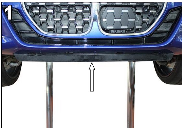
Abb. 1 Serienkunststofflippe unterhalb der Serienfrontschürze ausclipen. Wird nicht wiederverwendet.
