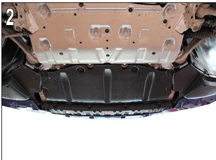
Abb. 2 Mittlere Unterbodenverkleidung ausbauen. Dazu 10 Befestigungsschrauben lösen.
