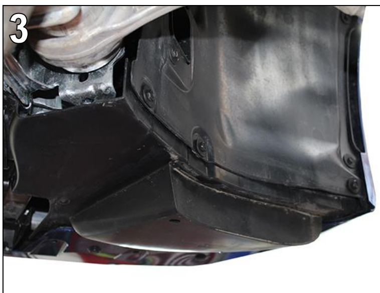
Abb. 3 Beide Unterbodenradhausverkleidungen rechts und links ausbauen. Dazu 3 Befestigungsschrauben in der Serienfrontschürze und 3 Befestigungsschrauben im Radhaus lösen.
