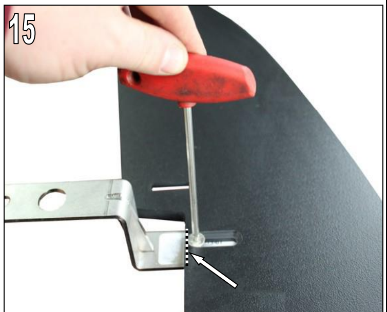
Abb. 15 AC Schnitzer Befestigungshalter mit der mitgelieferten Senkkopfschraube M6x10mm am AC Schnitzer Frontsplitter montieren und festziehen.
