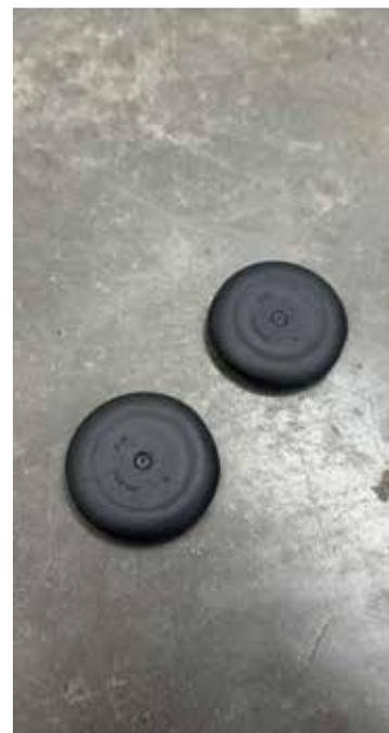
Die Stopfen benötigen nun ein Loch der Größe 5mm um das Kabel dort hindurchführen zu können. Anschließend muss noch ein Schlitz, am besten mit einem Seitenschneider von außen bis zum Loch hergestellt werden.
