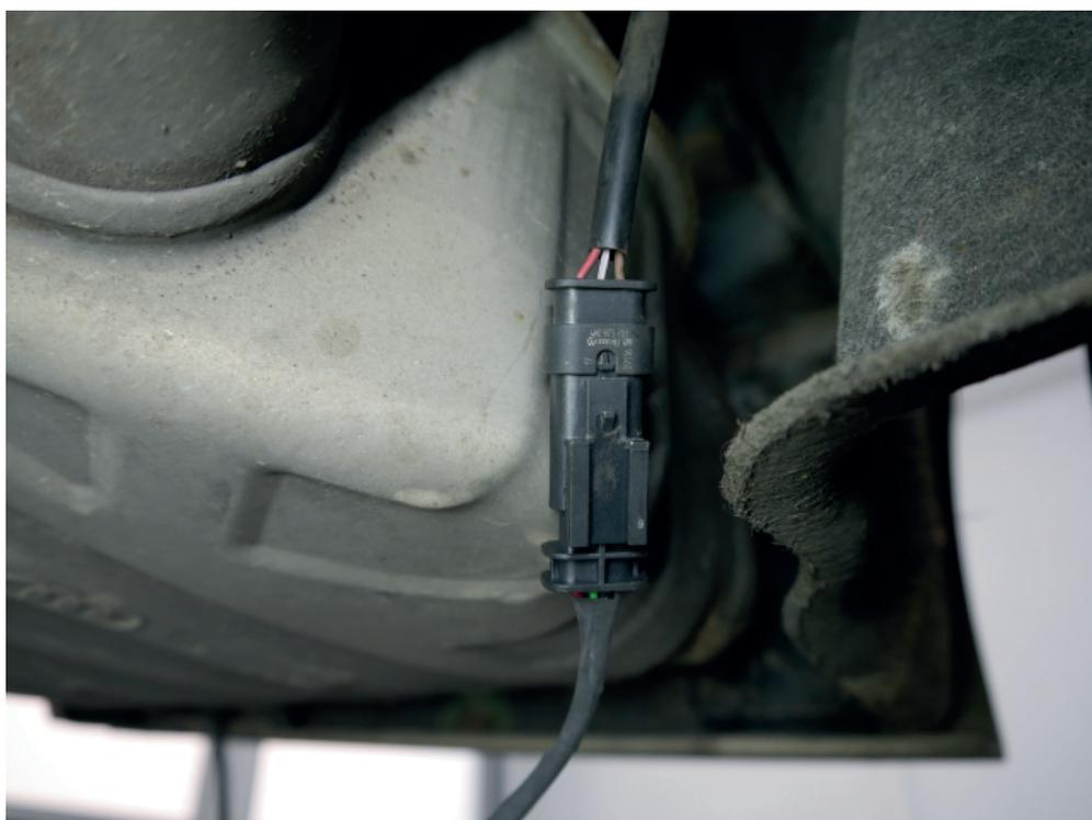
Kontrollieren Sie nach dem Zusammenstecken unbedingt die Stecker und Verriegelungen auf korrekten Sitz. Verlegen Sie die Kabel unbedingt knickfrei, vermeiden Sie enge Radien, verlegen Sie die Kabel nicht an beweglichen, heißen oder scharfkantigen Teilen. Kontrollieren Sie vor dem ersten Test und dem Montieren der Verkleidungen unbedingt noch einmal alle Stecker und Verbindungen.
