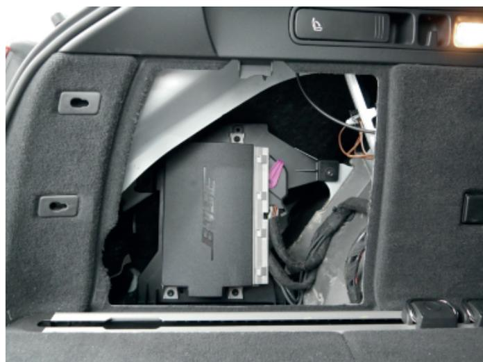
Lösen Sie die markierten Schrauben und nehmen Sie den Verstärker zur Seite:
