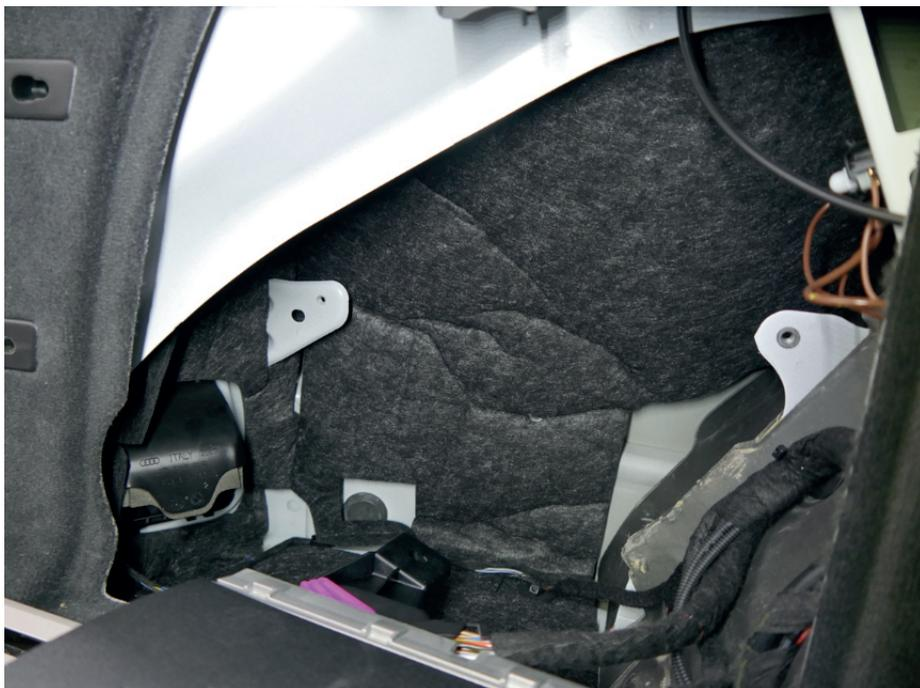
Nun können Sie die Kabel der Alpha Control durch die Kofferraumentlüftung nach außen in Richtung Stellmotoren verlegen. Das kurze Kabel wird an den linken Stellmotor verlegt, das längere Kabel an den rechten Stellmotor.
