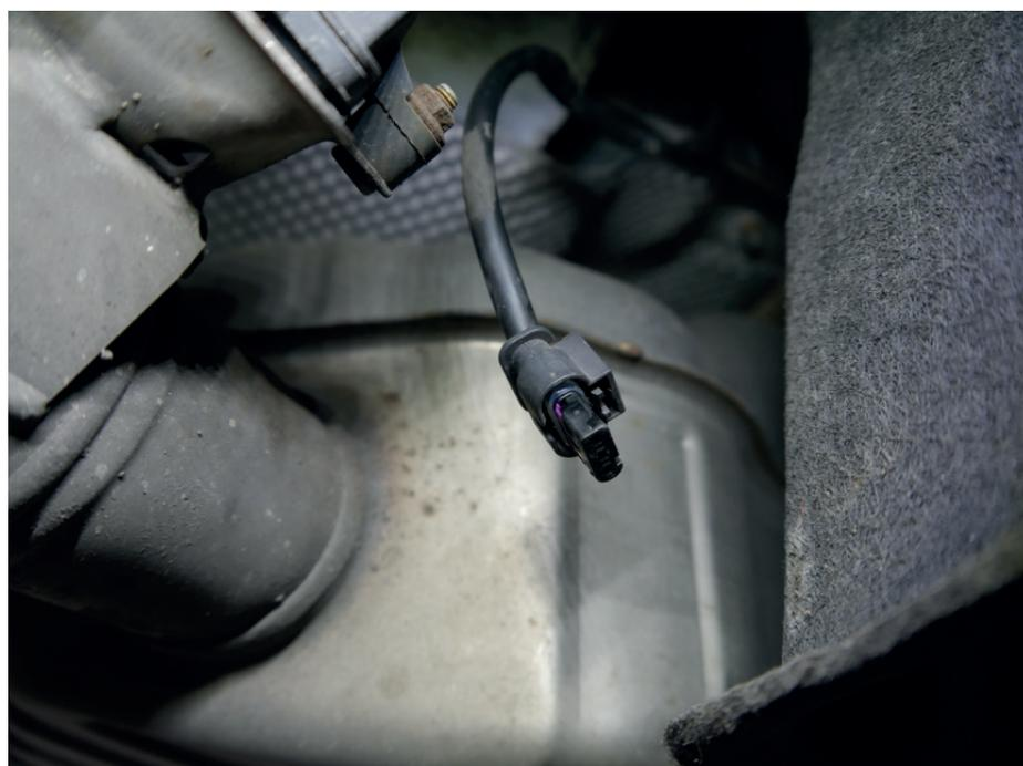
Anschließend können Sie die Stecker der Alpha Control mit dem fahrzeugseitigen Stecker und dem Stellmotor verbinden.
