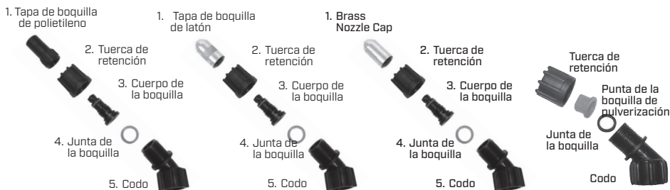
Figura 1 Boquilla ajustable de polietileno
