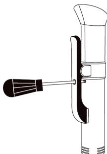
2. Ouvrez le boîtier en acier inoxydable en le faisant prudemment glisser vers le bas, afin d'exposer la pompe, l'élément chauffant et les capteurs de température.
