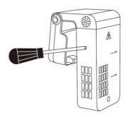
2. Deslice cuidadosamente la cubierta de acero inoxidable para poder ver la bomba, la bobina de calentamiento y las sondas de temperatura.
