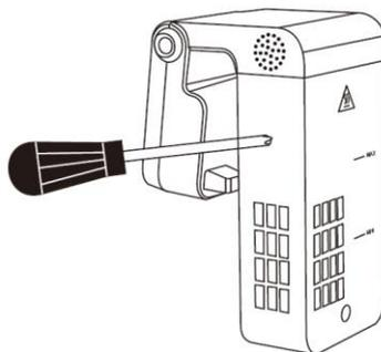
2. Faites doucement glisser le boîtier en acier inoxydable vers le bas, afin d'exposer la pompe, l'élément chauffant et les capteurs de température.
