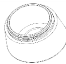
Cámara de combustión
