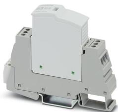
Protección contra sobretensiones de tipo 2/3, formada por una protección enchufable y un elemento de base con conexión por tornillo. Para redes de suministro eléctrico monofásicas con indicación de estado y señal remota integradas. Tensión nominal: 230 V AC/DC
