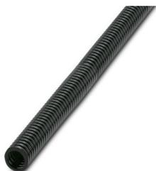
Tubo de protección, material: PA 6, resistente a los rayos ultravioleta: sí, flexible, índice de protección: IP68, color: negro, clase de inflamabilidad según UL 94: HB, diámetro interior: 10 mm, Longitud total: 50 m
