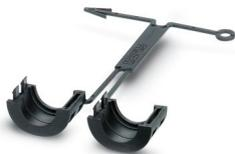
Clip de seguridad para el lado hembra de los cables para sensores/actuadores con conectores M12 y conectores M12 confeccionables, para moleteado con diámetro: 15 mm o para hexágono con ancho de llave de 14 mm, impide que las conexiones de enchufe se separen sin herramientas
