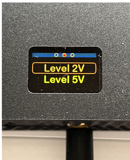
● DAC Mode的三種選擇，最上面的三個小圓圈代表三種選擇，紅點代表第幾種選擇。
