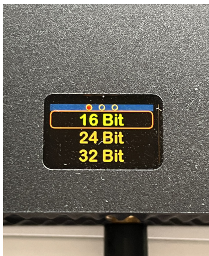
● DAC Mode的三種選擇，最上面的三個小圓圈代表三種選擇，紅點代表第幾種選擇。
