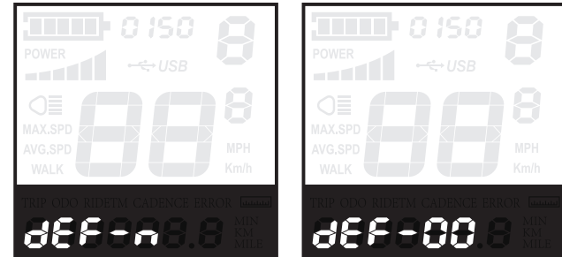
Schnittstelle zur Wiederherstellung der Standardeinstellungen
