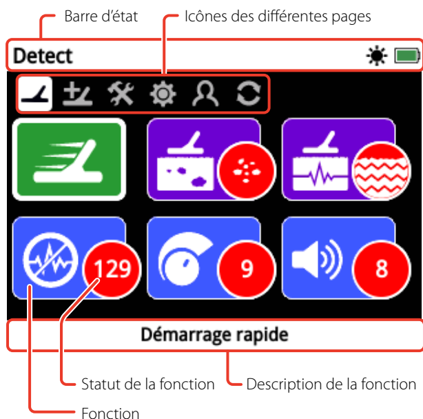
Les éléments d'une page-écran type du GPZ 7000
