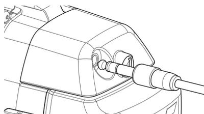
Si se usted utilizar auriculares impermeables, usted tendrá que quitar el módulo del auricular de la caja de control y tendrá de conectar los auriculares a la toma de auriculares expuesta, recordando siempre que es necesario apretar los anillos de retención.
