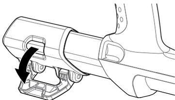
2. El eje intermedio sólo puede ser insertado en el eje superior en una orientación. Asegúrese de que la llave de bloqueo en el eje intermedio esté alineada con el eje superior.
