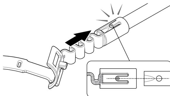
3. Fije la presilla /clip en forma de C, con el gancho apuntando hacia la manija de la Guía del Brazo GA 10. Aplique presión firme para romper el clip en el eje.
