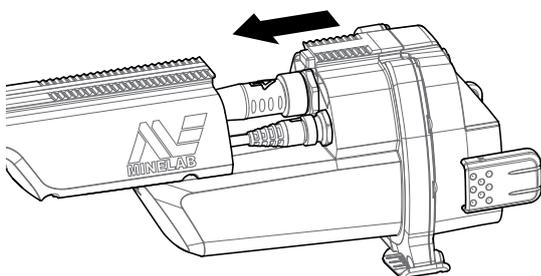
2. Conecte la bobina y los cables del panel de control a sus respectivos conectores y apriete firmemente los anillos de retención.
