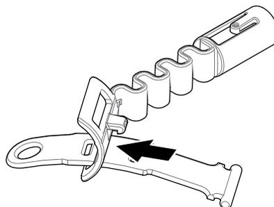
2. Conecte la unión flexible al eje de la Guía del Brazo GA 10. Alinee los agujeros en el eje con la llave en la unión flexible (Flex-link). Pulse la unión flexible en el extremo del eje hasta que encaje en su lugar.
