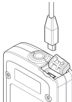
2. Conecte el otro extremo del cable de USB al cargador de baterías BC 10 o directamente a un puerto de USB en su PC.
