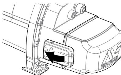
2. Coloque el módulo de auriculares en la caja de control. Utilice un destornillador o una moneda para apretar suavemente el tornillo, teniendo cuidado de no dañar la rosca por apretar demasiado.
