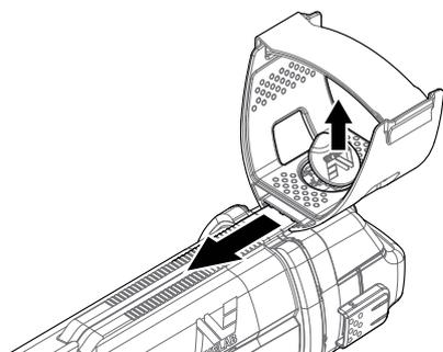
2. Deslice el apoya brazo a lo largo del carril de manera que se coloque cómodamente justo por debajo de su codo cuando usted sostenga el detector.
