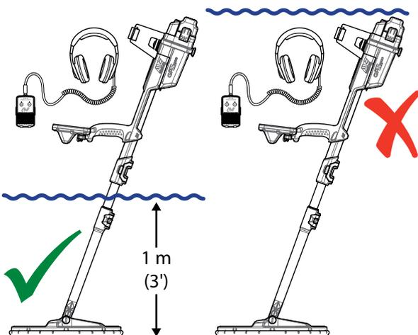
*La bobina GPZ 14 puede ser sumergida en agua hasta 1 m de profundidad. El cuerpo del detector y el modo WM 12 no deben ser sumergidos en el agua.*
