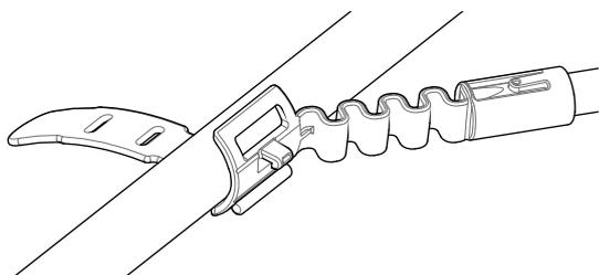
2. Envuelva la correa alrededor del eje y enganche en el extremo de la correa a través de la ranura en la unión flexible. Tire la correa apretada hasta que el gancho de la unión flexible esté a través de la primera ranura de la correa.
