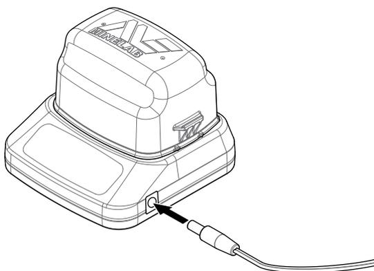
Conecte el otro extremo del cable en la toma de corriente y encienda el interruptor, o el enchufe en la toma del encendedor del coche. Si usted utiliza el cable de la conexión directa de la batería, primero conecte el negativo negro (-) al terminal negativo de la batería (-), y luego el positivo rojo (+) al terminal positivo de la batería (+).
