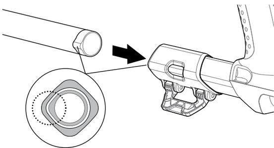
3. Deslice el eje intermedio en el eje superior hasta que aparezca la clave de bloqueo en la parte superior.
