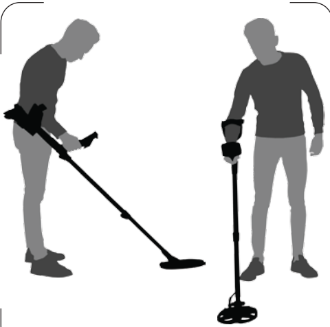
La altura del eje es incorrecta
