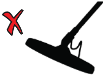
Angulo de bobina de búsqueda incorrecto
