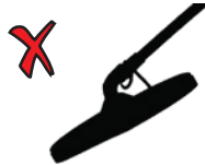
Angulo de bobina de búsqueda incorrecto
