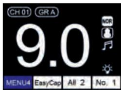
Das linke Bild zeigt die Einstellungen für zwei Blitzgeräte-Gruppen im Easy Cap-Modus. Stellen Sie mit der Funktions-Taste [13] entsprechend „All 2“ ein. Alle Blitzgeräte, die für die Ausleuchtung des Motivs zuständig sind, stellen Sie mit der Funktionstaste [14] auf „No. 1“. Sie werden bei der ersten Kamera-Auslösung gezündet.
