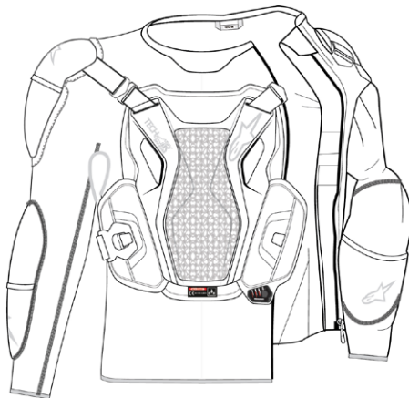
図14：アクティベーション・ジップ(1)を開いてシステム・スイッチを切る
