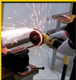
**1** Corte de barras de refuerzo, esmerilado de líneas de soldadura.
