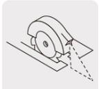
Láser auxiliar para guía de corte
