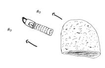
Insérez l'ampoule dans l'ouverture de Roucaou puis accrochez l'applique dans le sens que vous voulez sur les vis. (L'applique Roucaou est réversible)
