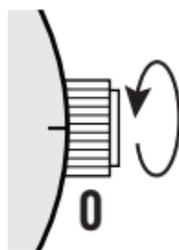
**ZUM LÖSEN:** Drehen Sie die Krone gegen den Uhrzeigersinn, bis sie sich ohne Spannung frei dreht. Ziehen Sie die Krone zur Einstellung der Uhr vorsichtig in die anderen gewünschten Positionen heraus (siehe spezielle Bedienungsanleitung auf den folgenden Seiten).
