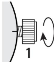
**ZUM VERSCHRAUBEN:** Drücken Sie die Krone ganz hinein (in Richtung der Uhr) und drehen sie dann im Uhrzeigersinn, bis sie fest verschraubt ist.
