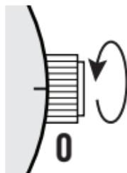
**ZUM LÖSEN:** Drehen Sie die Krone gegen den Uhrzeigersinn, bis sie sich ohne Spannung frei dreht. Ziehen Sie die Krone zur Einstellung der Uhr vorsichtig in die anderen gewünschten Positionen heraus (siehe spezielle Bedienungsanleitung auf den folgenden Seiten).
