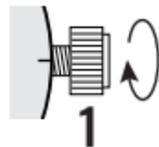
2. Wenn sie sich in Position [1] befindet, drehen Sie die Krone zum Aufziehen im Uhrzeigersinn. Ziehen Sie die Krone 5-10 Mal auf und sie beginnt sich nach leichtem Schütteln von selbst zu bewegen.
