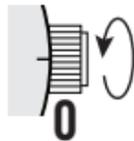
1. Schrauben Sie die Krone durch Drehen gegen den Uhrzeigersinn ab.
