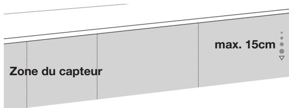
Pour tous les mouvements effectués sous les 15 cm, le capteur ne réagit pas.
