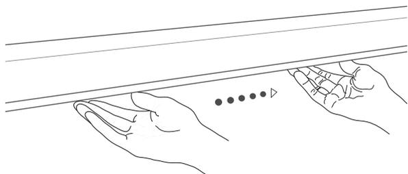
Une autre façon de déplacer le faisceau lumineux est de tenir votre main sous le capteur où vous voulez déplacer le faisceau lumineux. Le faisceau lumineux se dirige alors vers votre main.
