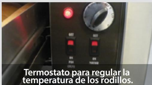
Termostato para regular la temperatura de los rodillos.
