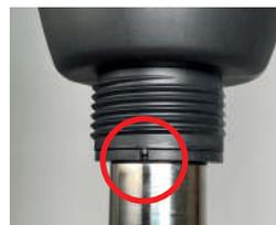
2. Una vez asegurados los candados mostrados en la imagen previa proceda a enroscar la tuerca campana (6) hacia arriba para fijarlos firmemente al cuerpo de la máquina (1).
