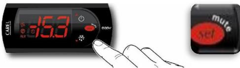
2. Si deseas aumentar el valor del SET POINT para una nueva temperatura, presione el botón de flecha hacia arriba. Pulse este botón para alcanzar el valor deseado, suelte el botón y luego presione el botón de SET para guardar el nuevo valor.
