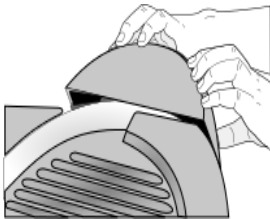
FIG 3. INSTALACIÓN DE AFILADOR
