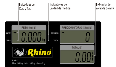
Pantallas de cuarzo con iluminación (backlight)
