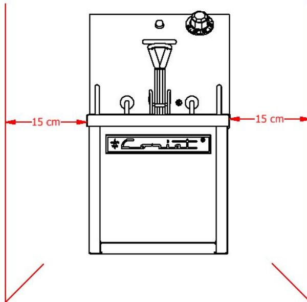
Es recomendable instalarlo bajo una campana de extracción, para asegurar la completa evacuación de los vapores y humos quemados en la fase de cocción.
