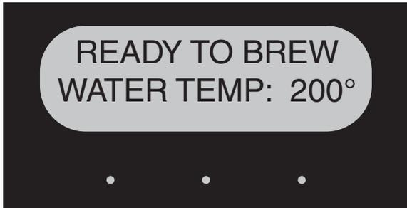
Esta pantalla aparece cuando el percolador está listo para usar. Esta pantalla muestra la temperatura del agua del tanque. Cuando el agua del tanque alcanza la temperatura ajustada debida, la pantalla cambiará de **HEATING (CALENTANDO)** a **READY TO BREW (LISTO A PERCOLAR)**.
