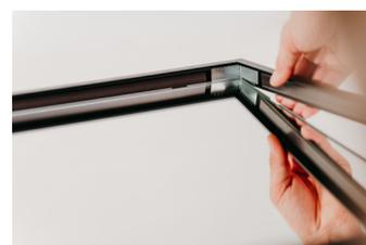
Grundrahmen an die gewünschte Position bringen und fest verschrauben. Prüfen Sie ob der Grundrahmen in Waage hängt und prüfen Sie die korrekte und feste Fixierung des Grundrahmens an Ihrer Einbausituation.
