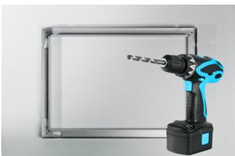
Bohren Sie die benötigten Löcher in die Wand. Achten Sie im Vorfeld darauf, dass sich keine Leitungen im Bohrbereich befinden und kontrollieren Sie den Bohrdurchmesser. Dübel in die Bohrlöcher stecken.
