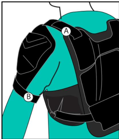
**A - SCHULTER- UND RÜCKENPLATTE KÖNNEN DURCH VERSTELLEN DES KLETTVERSCHLUSSES AM SCHULTERGURT POSITIONIERT WERDEN.**
