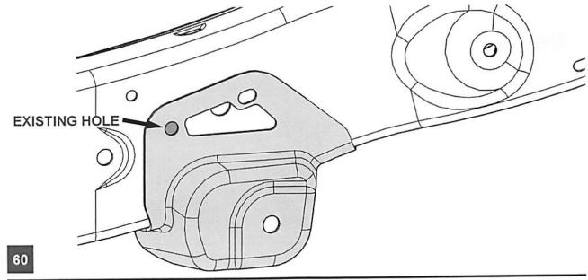
TEMPORARILY INSTALL THE FRONT BRACKET USING A FACTORY BOLT
