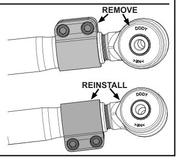
INSTALL THE FIXED END OF THE ALPINE CONTROL ARM TO THE AXLE WITH THE STICKER FACING OUT. LEAVE FINGER TIGHT.
