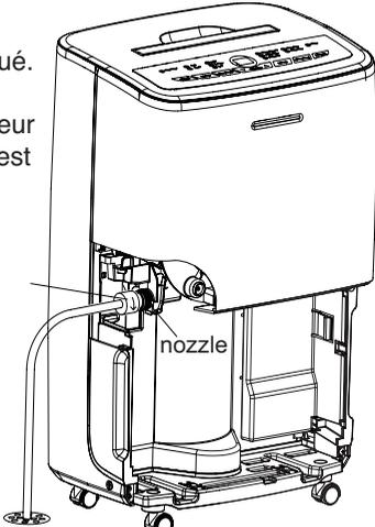
4. Replacer le réservoir dans l'unité. Assurez-vous que le boyau de drainage passe par l'ouverture du réservoir et que le boyau est en pente douce vers le drain de plancher. Couvrir le drain avec un couverc. Vous devez éviter un plancher inégal et qu'aucun coude n'empêche l'eau de circuler. (voir schéma).
