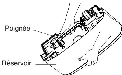
3. Replacer le réservoir dans le déshumidificateur tel qu'indiqué sur le schéma.
