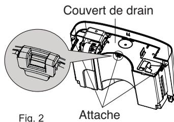
(3) Le nettoyage complété, replacer le couvert de drain et la poignée à leur place et assurez-vous que le flotteur du réservoir est bien à sa place et libre de mouvement. Le côté avec la mousse/plastique (flotteur) devrait être sous le couvert de drain. Ne pas retirer la mousse/plastique du flotteur.
