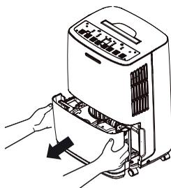
2. Vider le réservoir par la poignée du dessus et en soutenant le dessous. (voir schéma).
