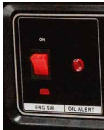
Figura 24 – Interruptor de control del motor
