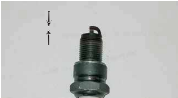
Figura 38 – Requisitos de separación de la bujía
