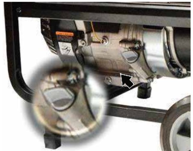
Figura 26 – Tapón de llenado/varilla de medición del aceite
