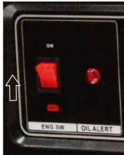
Figura 19 – Interruptor de control del motor
